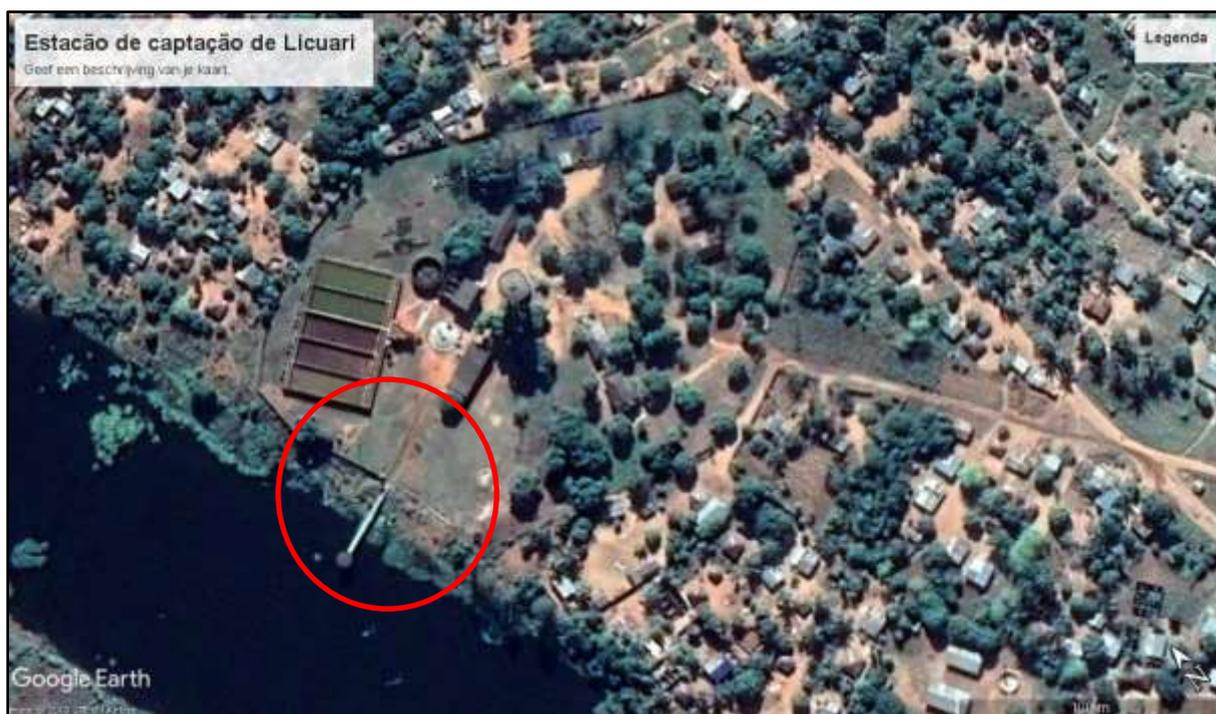
Figura 30 Estação de captação na Lagoa Namita em Licuári com os reservatórios e ETA..
